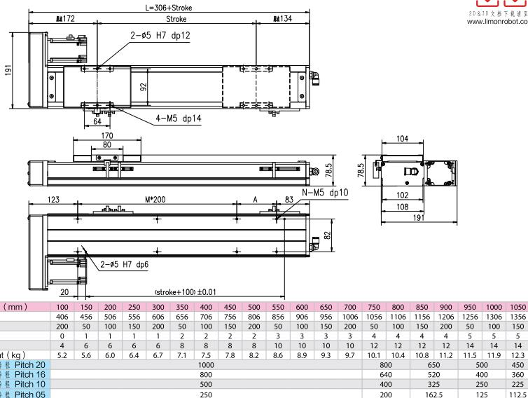
注：行程超過700mm時，根據動作區域不同，可能會出現滾珠絲杆的共振情況，應參考上表所示的最高速度。
