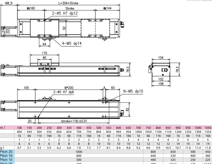
注：行程超過700mm時，根據動作區域不同，可能會出現滾珠絲杆的共振情況，應參考上表所示的最高速度。
